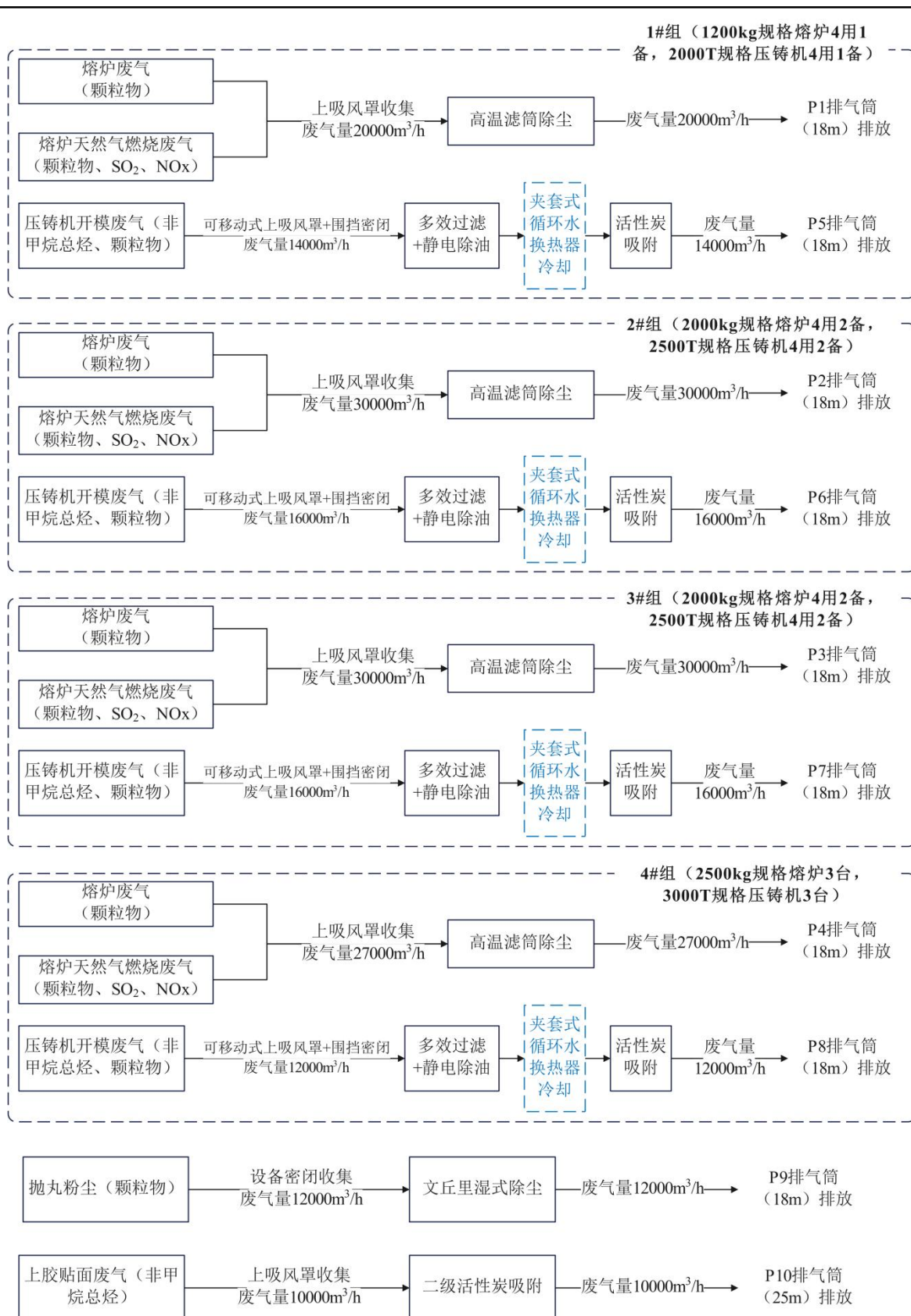
图 4-2 本项目废气收集处理流程图
